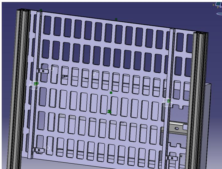
La fixation se fait sur la grille par le biais de petites pièces cylindriques qui servent d'entretoises, et de vis+rondelles/équerres
